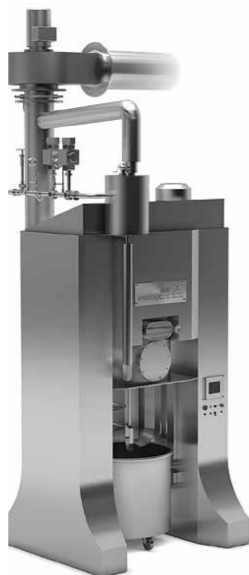
Mezcladora con tecnología de inyección LIN-IS superior
