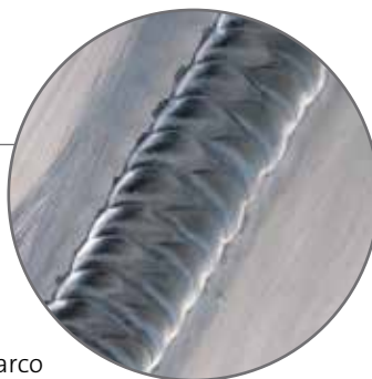
Soldadura a tope TIG con Alumaxx® Plus en aleación de aluminio 4140 de 10mm de espesor
