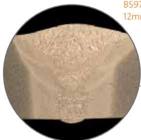
Soldadura en ángulo MAG con Ferromaxx® 15 en acero BS970:080M50 de 12mm de espesor.
