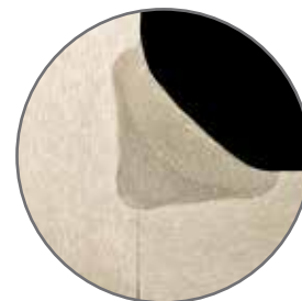
Soldadura en ángulo MIG en aleación de aluminio 4140 de 10mm de espesor con Alumaxx® Plus
