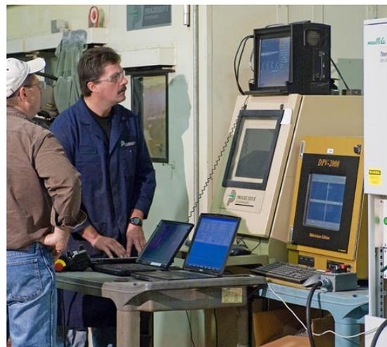
Con el sistema avanzado de tecnología de refrigeración para proyección térmica puede supervisar el proceso de dosificación desde la sala de control. El perfil de temperaturas del proceso se mostrará en la pantalla del ordenador y quedará guardado para su análisis, reproducción y examen posteriores.
