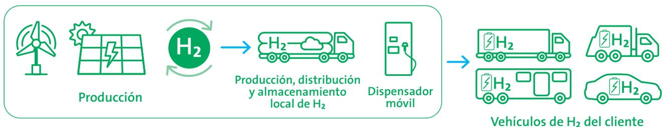
El servicio de dispensador móvil proporcionado por Carbuos Metálicos incluye la producción de hidrógeno, la entrega y el equipo de repostaje in situ
